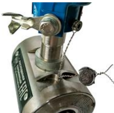
Рисунок 3 – Место установки пломбы
